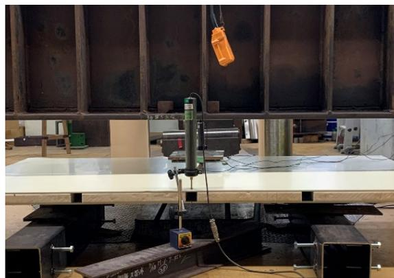
写真2 試験体の曲げ試験の様子
